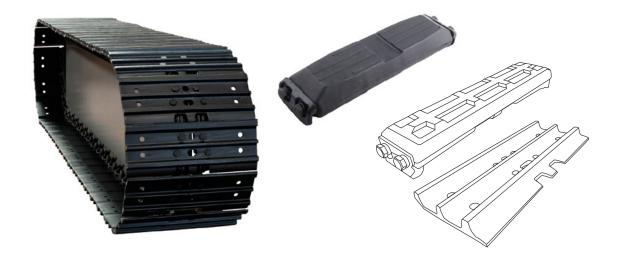
Mit der Clip-On-Bodenplatte kann jede Stahlkette in ein Gummilaufwerk umgewandelt werden.
